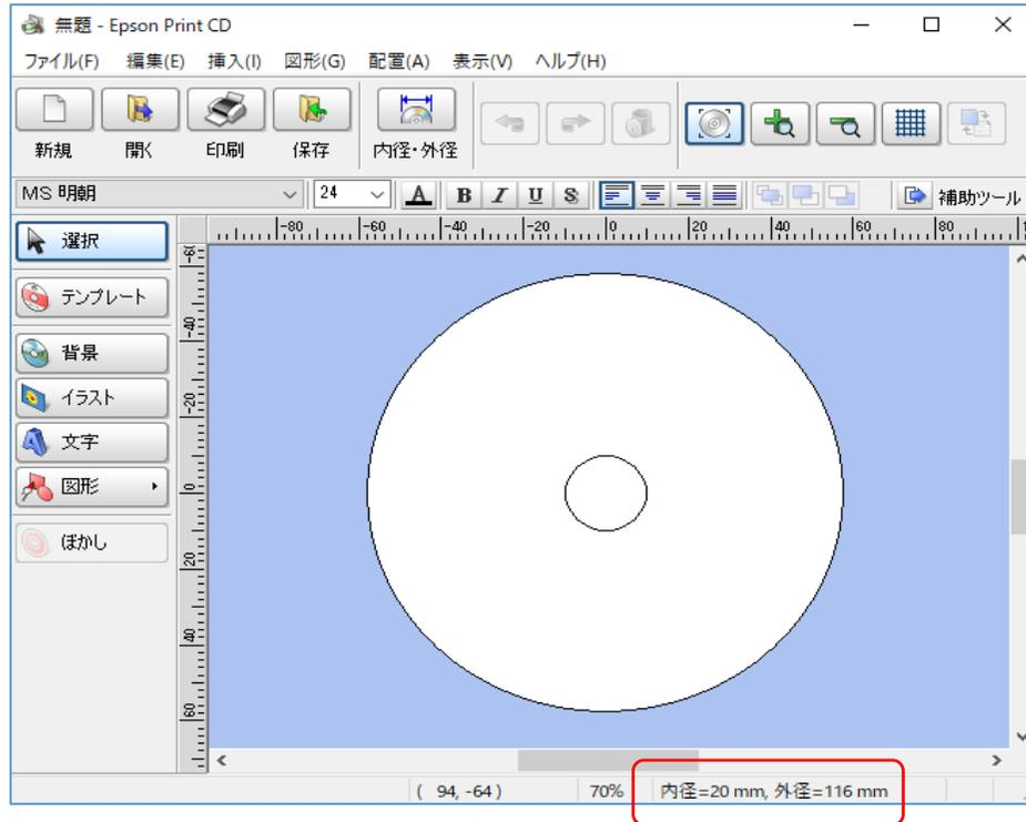
\* 内径20mm 外径116mmになっていれば標準サイズです。内径が大きいCD/DVDの場合は「内径・外径」ボタンをクリックして調整する必要があります。
